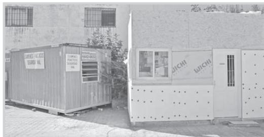
La Dirección municipal de Licencias recibió de la Cámara de la Construcción Argentina la donación de una nueva oficina móvil construida a partir del sistema Steel Framing, el que contempla un entramado de perfiles conformado de chapas laminadas en frío de acero galvanizadas.
