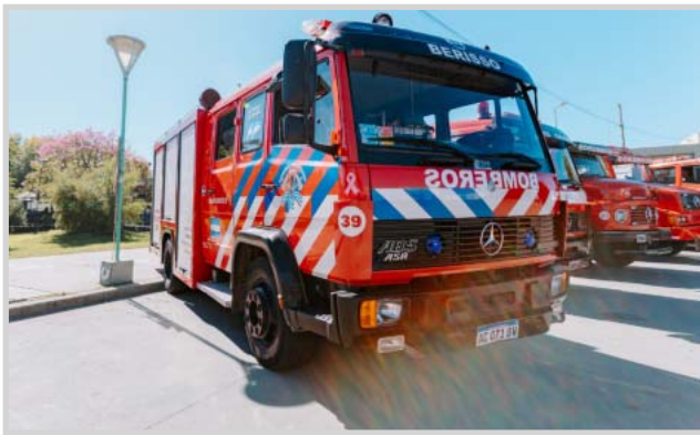
El MÓVIL 39 es una autobomba liviana alemana modelo 1995, a la que pueden subir siete bomberos con dos mil litros de carga de agua.
