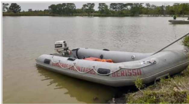
Los MÓVILES 20 A 22 son embarcaciones semirrígidas, una de marca Kiel 4.60 con motor Evinrude 25 HP y las dos marca BIM 4.20 con motor Johnson, de 30 y 35 HP respectivamente.
