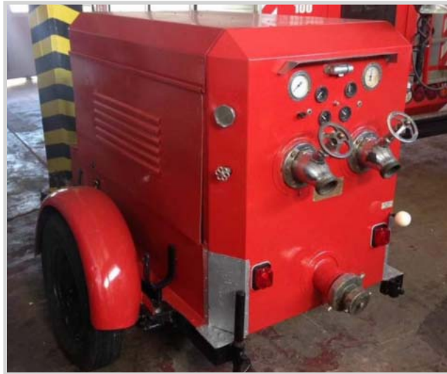
La MOTOBOMBA 1 es una de las unidades más antiguas aún en funcionamiento. Es de origen nacional y está montada sobre un chasis transportable.
