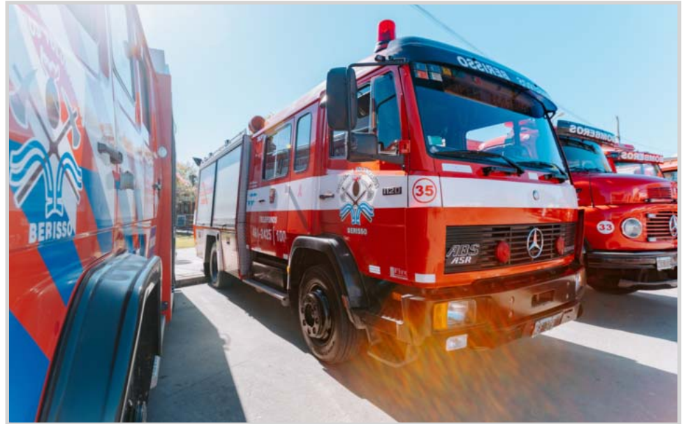
El MÓVIL 35 es una autobomba liviana holandesa modelo 1992, con una cisterna de 1.500 litros y transporta hasta siete bomberos.
