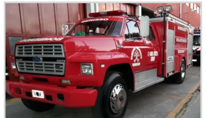
El MÓVIL 27 es una autobomba pesada Ford 7000 modelo 1985, con capacidad para la carga de 5.500 litros de agua.
