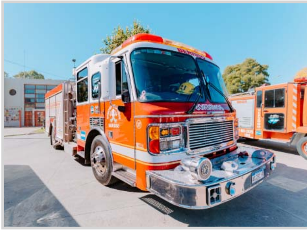
El MÓVIL 37 , una autobomba pesada marca American Lafrance modelo 2002, fue adquirido por Bomberos en 2016. Es una unidad de origen norteamericano, única en la región, que permite trabajar combatiendo incendios de magnitud tanto estructurales como industriales. Carga 3.800 litros y tiene capacidad para 8 tripulantes.
