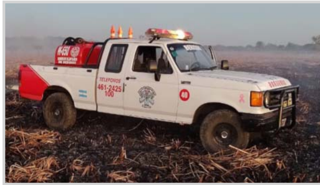
El MÓVIL 40 es una Ford F-100 Transporte de personal con kit de ataque rápido, 650 litros, cinco bomberos, modelo 1995
