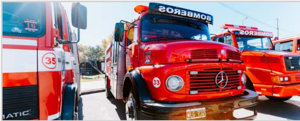
El MÓVIL 33 es una autobomba pesada Mercedes Benz modelo 1979, fue donada por YPF, tiene una capacidad de carga de 5.500 litros y espacio para cinco tripulantes.
