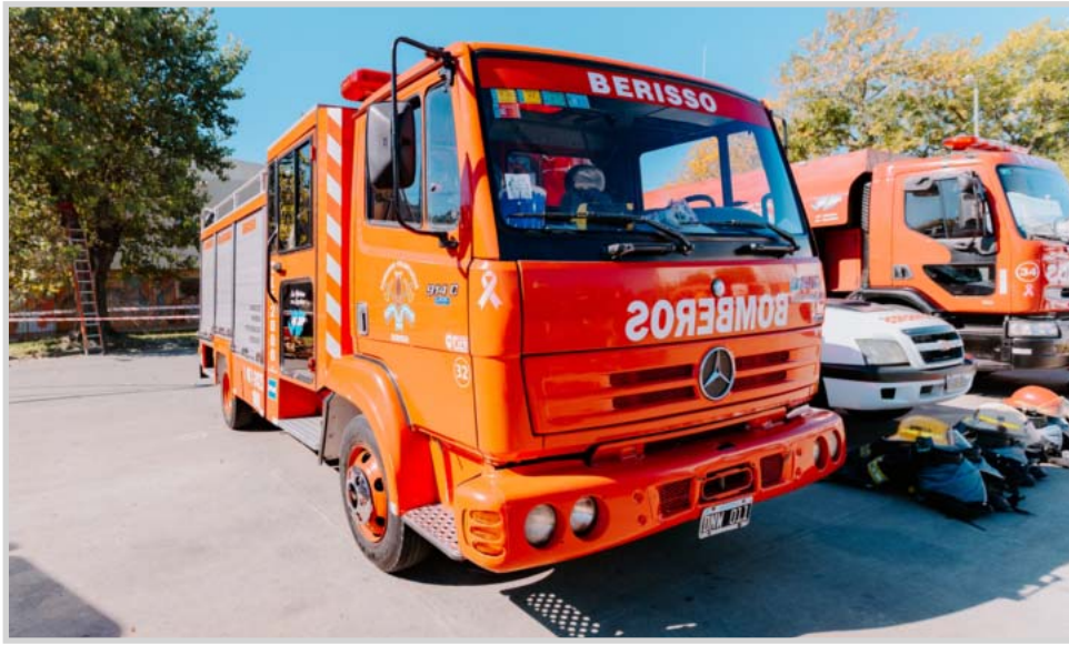
El MÓVIL 32 es una autobomba liviana marca Mercedes Benz y modelo 2000 que carga 2.200 litros y permite viajar a siete bomberos.
